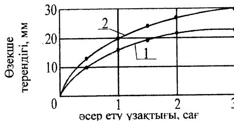
5.1 сурет - Температура -10^{\circ}\text{C} болған кезде ХКНН реагентінің әрекет ету ұзақтығының өзекше тереңдігіне әсері: 1 – Кристалл ірілігі 8 > K > 7 мм; 2 – Кристалл ірілігі 11 > K > 10 мм.
