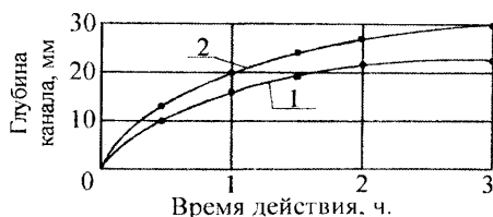
Рис. 5.1 Влияние продолжительности действия реагента ННХК на глубину каналов при температуре -10^{\circ}\text{C} :
